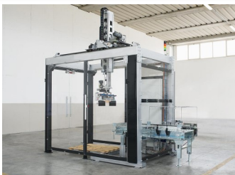
Palettiseur cartésien : les produits sont pris par un ou deux et sont déposés sur une ou plusieurs palettes. La cadence ne dépasse pas 10 à 12 coups par minute en fonction des opérations. La tête à une rotation de 360°
