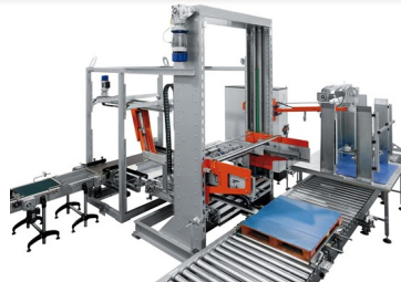
Palettiseur cartésien : les produits sont pris par un ou deux et sont déposés sur une ou plusieurs palettes. La cadence ne dépasse pas 10 à 12 coups par minute en fonction des opérations. La tête à une rotation de 360°
