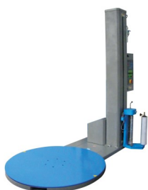
Filmeuse manuelle avec cycle automatique
