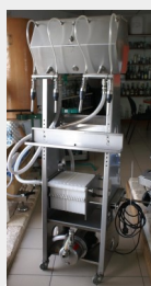
Tireuse 4 becs Haute Avec pompe et filtre à plaques
